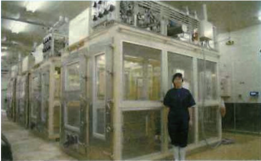
牛を中に入れてメタンガスを測定する「開放式呼吸試験装置」（農研機能のHPより）
