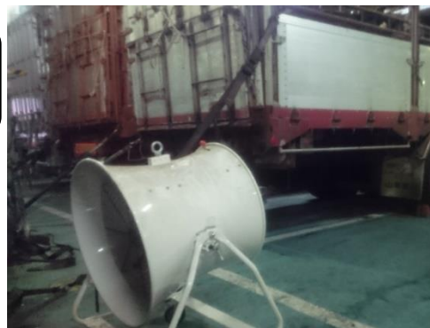
換気のための扇風機を 設置（船内）
